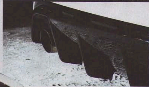
Serienmäßiger Diffusor mit 100er Endrohren
